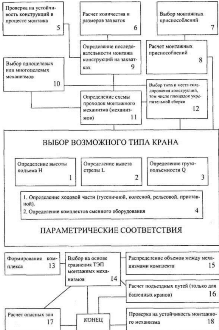
Рис. 6.1. Укрупненная блок-схема выбора монтажного крана
