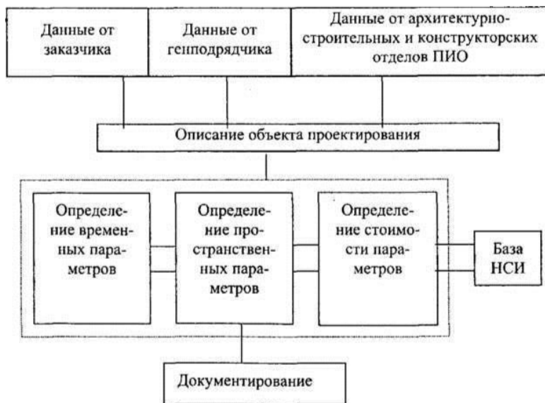
Рис. 1.3. Укрупненная схема автоматизированной технологии разработки документации по организации строительства
